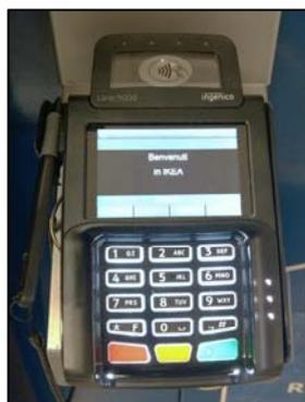
La nuova fornitura prevede l'installazione delle nuove **PIN Pad Lane/5000**, basate sulla piattaforma operativa **Telium TETRA**, dotate di ampio display touch-screen a colori e lettori di carte ben visibili al cliente che può quindi procedere autonomamente nelle operazioni di pagamento. I nuovi dispositivi Ingenico sono certificati secondo gli ultimi standard di sicurezza bancaria PCI-PTS V4.
